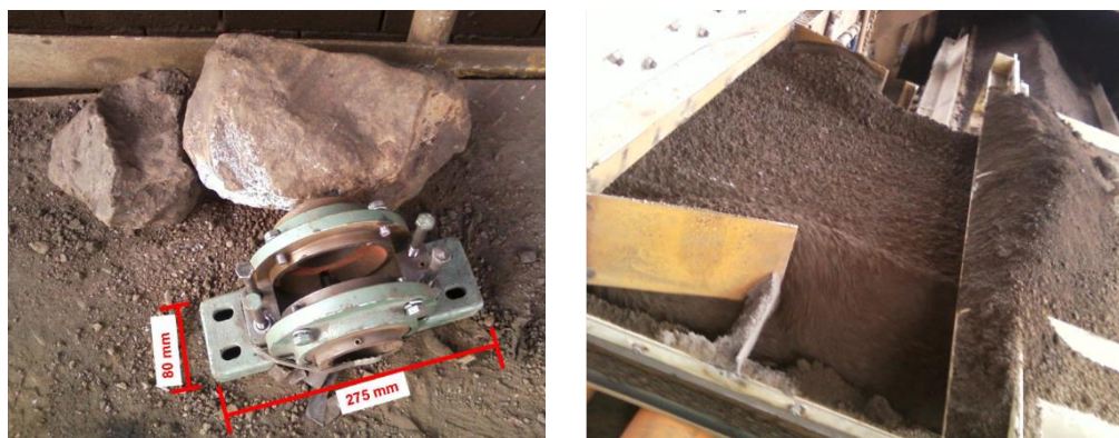
Figura 12. (a) Exemplo de Mataco presente na mistura; (b) Saída do Cone do Alimentador de Correia sem a Comporta Ajustável. Fonte: Autor.
